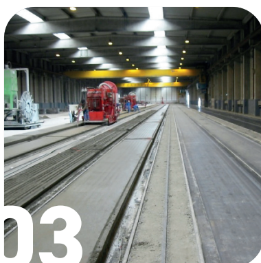
DALLES COULÉES PRÊTES À L'ÉTUVAGE
