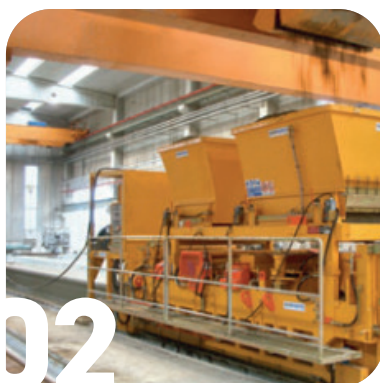
COULAGE DES DALLES PAR FILEUSE DOUBLE À COFFRAGE GLISSANT
